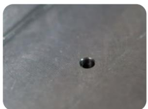
Der definierte Schneidprozess mit einem beschichteten Hartmetallmesser sorgt für einen vollständigen Kantenbruch – die Kante ist gratfrei.
