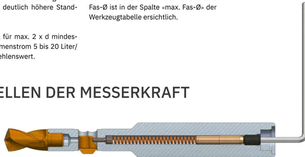
Die Messerkraft beim VEX-S kann mit Hilfe des Gewindestifts auf die Anwendung angepasst werden. Die Messerkraft soll so stark eingestellt werden, dass nach dem Austritt des Messers aus der Bohrung das Messer vollständig ausfährt. Damit ist sichergestellt, dass das Messer auch die nötige Schneidleistung aufbringen kann. Je zäher der Werkstoff, desto härter soll die Feder eingestellt werden.
