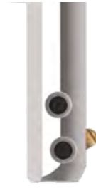
Posición inicial de la cuchilla para mecanizado hacia delante
