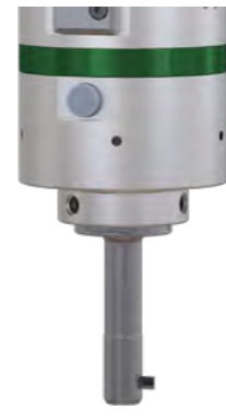
SOLO2 – Le couteau est déployé à l'arrêt (arrêt de la broche). Cet outil est utilisé jusqu'à une vitesse d'usinage maximale de 1500 tr/min. La vitesse de rétractation du couteau dans le porte-couteau est de 1900 tr/min.
