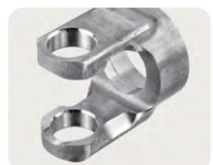
Ébavurage régulier des arêtes de trou, indépendamment de la hauteur du plan d'usinage. Cela compte particulièrement pour les pièces moulées.
