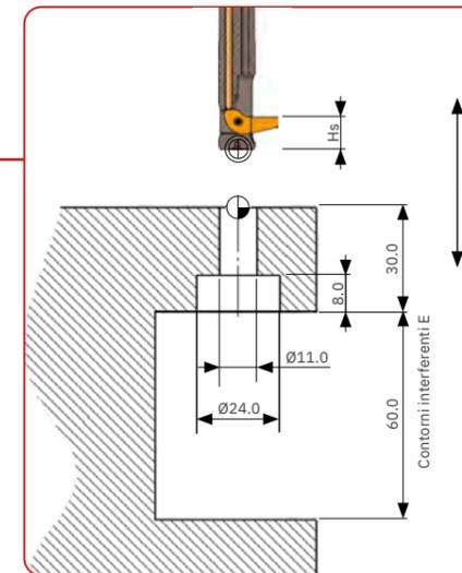
Foro retrolamato M10 per vite a brugola con esagono interno conforme a DIN 974-1
