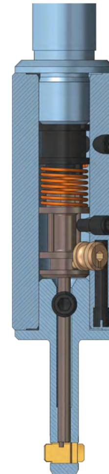
L'utensile di smussatura DEFA è caratterizzato da due lame con una speciale geometria di taglio. Le due lame di smussatura sono tenute in movimento nel corpo utensile da un'unità controllo lama sotto pressione elastica.
