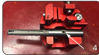
Setzen Sie den Werkzeugkörper mit dem Schwerspannstift nach oben auf die vordere Auflage.
