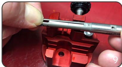
Heben Sie die Feder an und schieben Sie diese über den Spannstift, indem Sie die Spitze auf den Stift der Montagevorrichtung drücken und gleichzeitig das hintere Ende in den Werkzeugkörper schieben.
