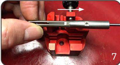
Nun wird die Vorspannung gelöst und die Feder kann mit Hilfe des Stifts des Montagewerkzeugs oder des Stifts der Montagevorrichtung leicht aus dem Werkzeugkörper zurückgeschoben werden.
