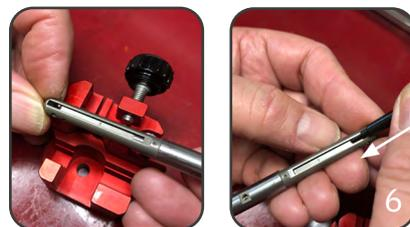
Schieben Sie die Feder – an der Vorderkante der Feder – über den vorgespannten Stift zurück, indem Sie zuerst den Stift der Montagevorrichtung und dann den Stift des Montagewerkzeugs verwenden.
