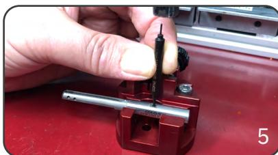
Entfernen Sie den Schwerspannstift, indem Sie das Montagewerkzeug einsetzen und ihn mit einem kleinen Hammer langsam aus dem Werkzeugkörper ausschlagen.
