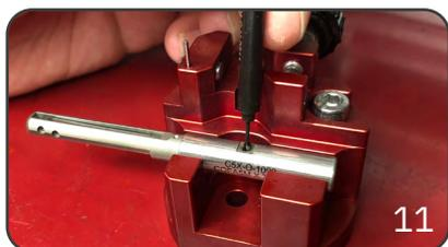
Setzen Sie den Werkzeugkörper auf das vordere Bett der Montagevorrichtung und setzen Sie den Spannstift mit dem Montagewerkzeug und einem kleinen Hammer ein.
