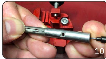
Überprüfen Sie die Position der Feder. Die Bohrung für den Spannstift muss sich an der gleichen Stelle wie die Bohrung im Werkzeugkörper befinden.
