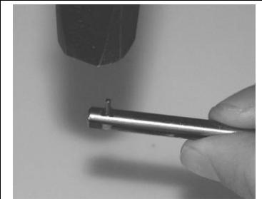
4. Mit einem kleinen Hammer vorsichtig den Spannstift einschlagen, bis dieser mit dem Grundkörper bündig ist (beidseitig).
