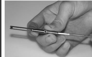
2. Richten Sie die Feder mit Hilfe eines Schraubenziehers genau auf das Querloch aus.
