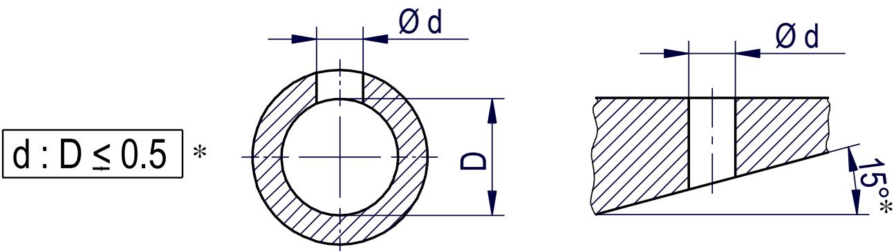
Das maximale Durchmesserverhältnis ( $d:D$ ) liegt bei 0.5. Dies entspricht auch in etwa einer schrägen Fläche von ca. 15°.
