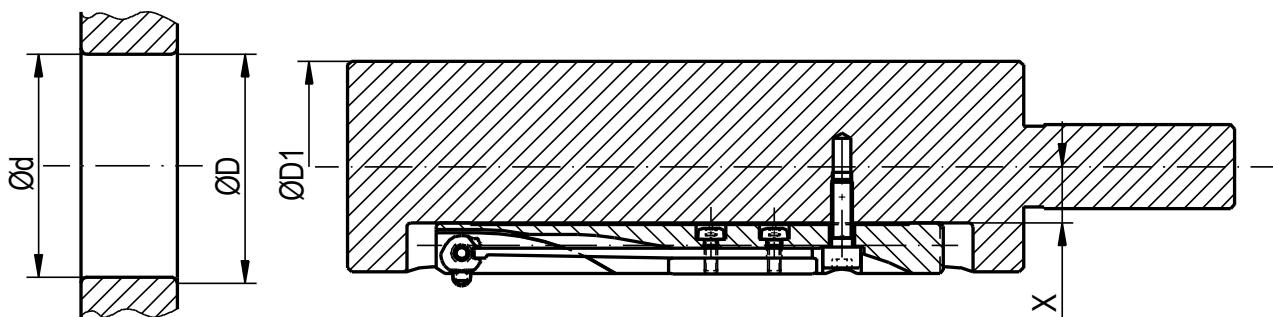
Die COFA-Kassette wird für den Einbau in Kombiwerkzeuge und Kassettenhalter verwendet. Der benötigte Kassettenhalter kann bei uns bestellt werden oder vom Kunden nach den nachstehenden Angaben selber hergestellt werden.
