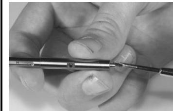
3. Setzen Sie den Schwerpunktstift in die Querbohrung mit der Freistellung. Schieben Sie den Montagestift mit dem längeren Ende in den Schwerpunktstift.
