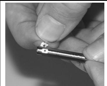
2. Den Montagestift mit der langen Seite durch die Bohrung fahren und das Messer zentrieren.
