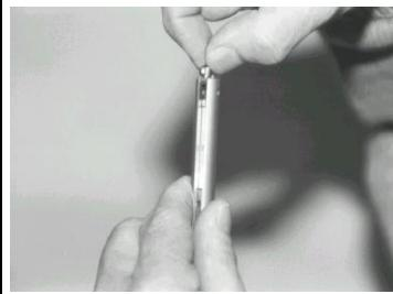
2. Montagestift mit der langen Seite durch die Bohrung fahren und Messer zentrieren (auf der rechten Seite des Werkzeugs, gemäss Bild).
