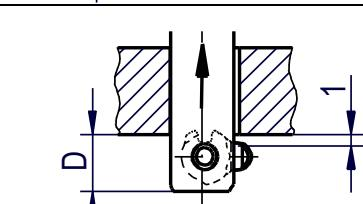
6. Im Arbeitsvorschub rückwärts wird die Zerspanung durchgeführt, bis Position **E**.
