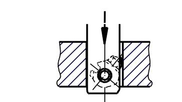
4. Damit das Messer wieder ausklappt, muss um das Mass **C** über die hintere Bohrungs- oder Gratkante hinausgefahren werden.
