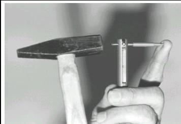
5. Montagestift herausnehmen und mit der kurzen Seite links ins Werkzeug schieben. Dann den Schwerspannstift bis zum Anschlag ins Werkzeug treiben.
