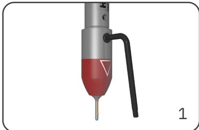
Mit Hilfe des mitgelieferten Torx-Schlüssels die Klemmschraube lösen.
