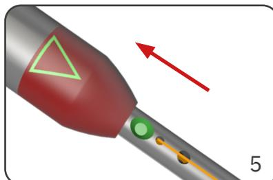
Das Messergehäuse wieder in den Grundkörper schieben. Der Pfeil auf der Kühlmittelhülse ist dabei auf die Bohrung der Klemmschraube ausgerichtet.
