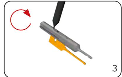
Einen spitzen Gegenstand in die kleine Bohrung an der Unterseite einführen und das Messer aus dem Messergehäuse schieben.
