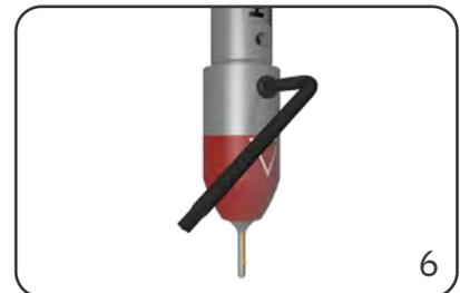
Um den Messerwechsel abzuschliessen, die Klemmschraube mit Hilfe des Torxschlüssels anziehen.
