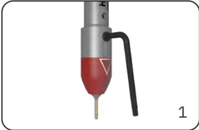
Mit Hilfe des mitgelieferten Torx-Schlüssels die Klemmschraube lösen.
