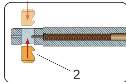
Das neue SNAP-Messer mit dem Messer-Rücken voran in das Messerfenster drücken bis es einschnappt. Darauf achten, dass die Steuernute (2) in Richtung Steuerbolzen zeigt.
