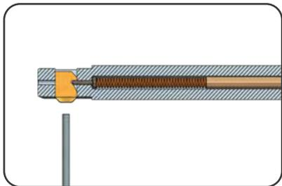
Werkzeug mit SNAP12-Messer montiert.
