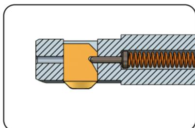
Der Steuerbolzen ist in der Messernute. Das Werkzeug ist wieder einsatzbereit.
