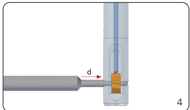
Mit Hilfe des Montagestiftes (stufenlose Seite) wird der Spreizstift nun bis zum Anschlag am Messergehäuse vorsichtig eingeschlagen (d). Messer ist fixiert. Funktionskontrolle durchführen.
