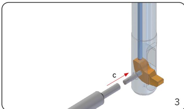
**Montage** – Messer einsetzen. Spreizstift mit der schlitzfreien Seite einführen und das Messer positionieren (c).
