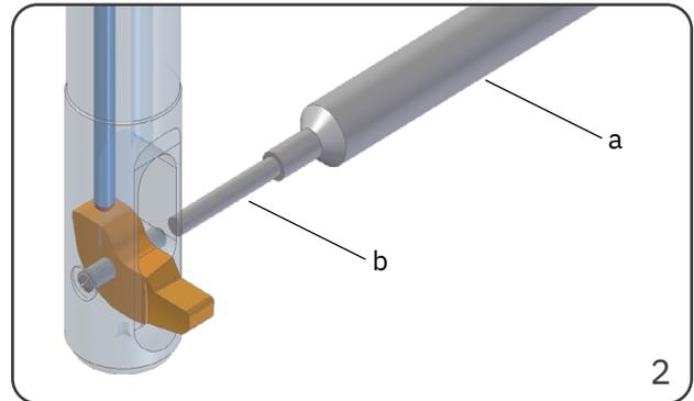
Montagestift an der schlitzfreien Seite des Spreizstiftes ansetzen. Montagestift bis zum Anschlag am Messergehäuse treiben. Messer ist frei und kann entnommen werden.
