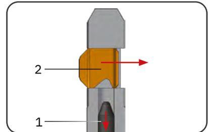
Durch die Bewegung der Exzentrerschraube wird der Steuerbolzen (1) nach unten/hinten aus der Bolzennute des Messers gezogen, dadurch kann das Messer (2) einfach in Pfeilrichtung herausgestossen werden.
