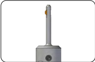
Werkzeug mit SNAP2 Messer montiert.
