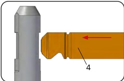
Bei der Montage eines neuen Messers mit integrierter Montagehilfe (4) darauf achten, dass das Messer mit der Schneidgeometrie voran wie abgebildet in das Messerfenster geschoben wird.
