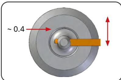
Montagehilfe des Messers entfernen, indem das Messer um ca. 0.4 mm mit dem Finger zurückgeschoben wird, bis sich die Sollbruchstelle auf der Höhe der Messerfenster-Kante befindet. Danach die Montagehilfe mit dem Daumen und Zeigefinger abbrechen.
