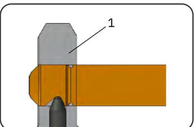
Durch das Zurückdrehen der Exzentrerschraube fährt der Steuerbolzen in die Steuernute des Messers.
