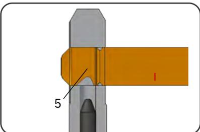
Das Messer so weit einschieben bis die Steuernute des Messers (5) über der Bolzenquerbohrung steht. Als optische Hilfe darauf achten, dass die Messerschneide auf der freigestellten Messerfensterseite vollständig herausragt.
