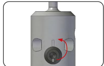
Zurückdrehen der Exzentrerschraube um 180° bis die Kerbe am Exzenter wieder auf die Kerbe am Grundkörper zu liegen kommt.
