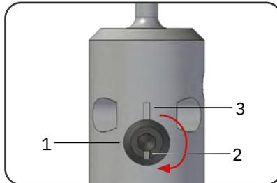
Exzentrerschraube (1) um 180° drehen bis die Kerbe am Exzenter (2) 180° zur Kerbe am Grundkörper (3) steht.
