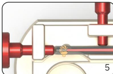
Das Messer in das Werkzeug einsetzen mit der Messernute zur Feder. Bitte beachten Sie die Markierungen auf dem Werkzeugkörper.
