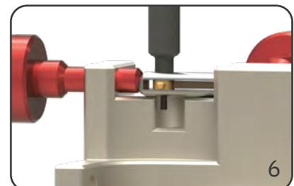
Den Montagestift mit dem langen Ende durch die Bohrung fahren und das Messer zentrieren.
