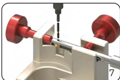
Den Spreizstift - mit dem Schlitz nach oben - von Hand einführen und mit dem Montagestift hineindrücken.
