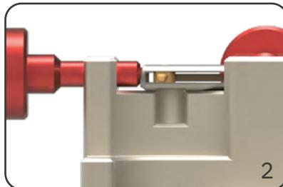
Längsjustierung so einstellen, dass die Messerbohrung über der Auffangbohrung für den Spannstift zu liegen kommt. Anschließend Werkzeug in Position wie abgebildet festklemmen.
