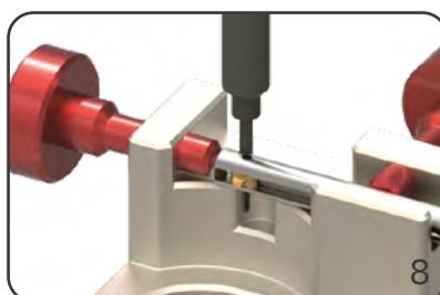
Der Spreizstift muss auf beiden Seiten mit dem Grundkörper bündig sein.
