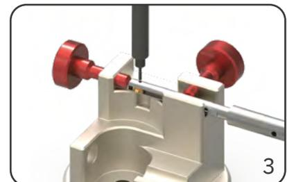
Spreizstift mit Hilfe des Montagestifts (größerer Durchmesser) vorsichtig aus der Bohrung vorsichtig aus der Bohrung drücken, falls nötig mit dem Hammer nachhelfen.
