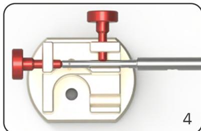
Das Messer mit Hilfe des Montagestifts (Ende mit kleinerem Durchmesser) aus dem Messergehäuse hinaus nach hinten schieben.
