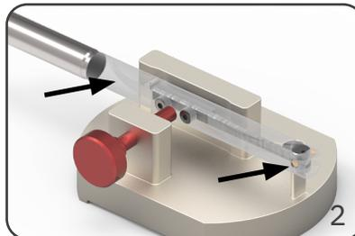
Werkzeug so in die Montagevorrichtung legen, dass der Trägerstift der Montagevorrichtung in die Federhut-Öffnung hinter der Klemmleiste greift und der Messerhalter mit der Kontur bündig auf die vordere Auflage zu liegen kommt.
