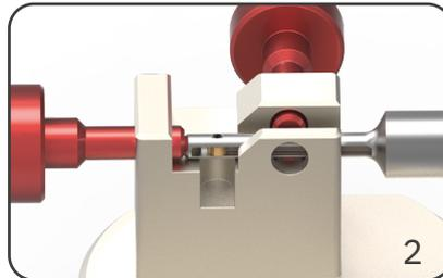
Längsjustierung so einstellen, dass die Messerbohrung über die Freistellung für den Spannstift zu liegen kommt. Dann das Werkzeug festklemmen. Beachten, dass die grössere Federfreistellung im Schaft auf die Seite der Klemmschraube zu liegen kommt.
