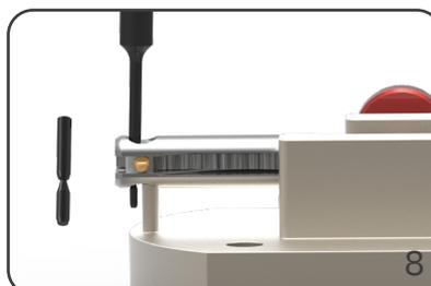
Neuen Spreizstift mit dem kürzeren Teil voraus in die Öffnung treiben, bis das hintere Ende bündig mit dem Messerhalter ist.
