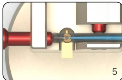
Neues Messer mit der Nase voran in das Messerfenster einführen. Die Nase muss auf der Seite mit der grösseren Federfreistellung liegen (Markierung beachten). Die Feder muss in der Federnute einrasten und die Position der Lagerbohrung in etwa passen.
