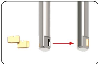
Ersatzmesser, sauber gereinigt und als Paar so einschieben, dass sie etwa bündig mit dem Aussendurchmesser des Werkzeuges stehen.
