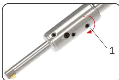
Spannschraube (1) soweit nach rechts drehen bis gewünschte Messerkraft erreicht ist. Die zuvor eingestellte Fasengrösse wird durch den Messerwechsel nicht verändert. Einstellwerte für die Messerkraft siehe Seite 109.
