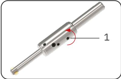
Spannschraube (1) nach links drehen bis sich die Messer leicht von Hand zusammendrücken lassen. Nur bei entspannten Messern Messerwechsel vornehmen.
