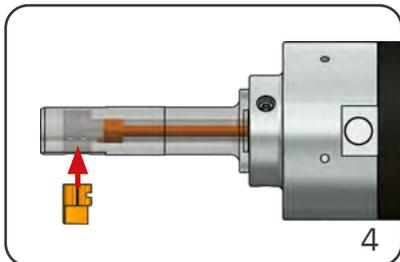
Messer ins Messerfenster einführen bis Schneide noch komplett sichtbar ist - hierfür die Knöpfe an der Steuereinheit gedrückt halten.
