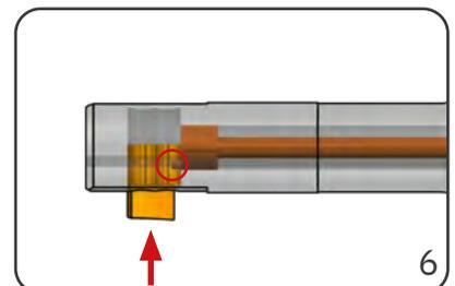
Messer in Messerfenster so verschieben bis der Wippenbolzen wieder ins Messer einrastet - es wird ein deutliches Klicken hörbar.
