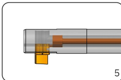
Seitliche Knöpfe loslassen. Kontrollieren, dass die Knöpfe ausgefahren sind.
