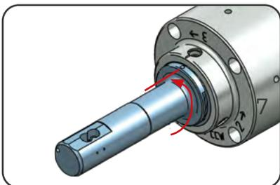
Danach Markierungen von der Steuereinheit und dem Messergehäuse zueinander positionieren.
