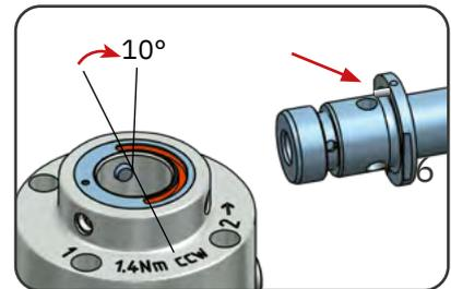
Messergehäuse auf die Steuereinheit montieren. Achten Sie darauf, dass der Positionsbolzen ca. 10° verdreht in die Freistellungsnut des Messergehäuses montiert wird.
