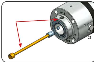
**Montage:** Wippe (Schnappverschluss + Dichtung) mit etwas Kraft in die Steuereinheit drücken bis die Wippe hörbar einrastet. Achtung: Positionsmarkierung an der Wippe und an der Steuereinheit müssen übereinstimmen.
