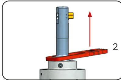
Messergehäuse nach vorne, von der Steuereinheit wegziehen. Der Messergehäuse-Schlüssel vereinfacht die Demontage und sollte immer verwendet werden.
