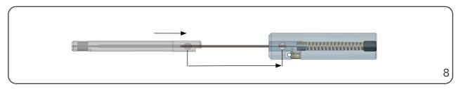
Schritt 8: Spitze des Steuerbolzens in das neue Messergehäuse einführen und dieses in den Grundkörper einschieben. Die Fixieraussparung für die Klemmschraube exakt unter der Öffnung des Klemmschraubenlochs positionieren. Anschliessend die Klemmschraube einsetzen und festziehen, sodass diese bündig unter der Oberfläche des Grundkörpers liegt.
