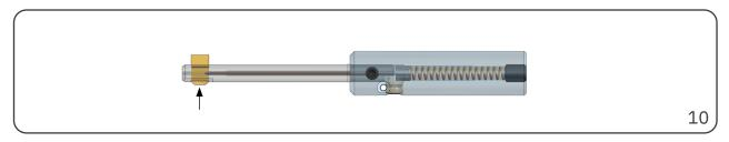
Schritt 10: Zum Einsetzen des Messers die Anweisungen in unserem Katalog oder Anleitungsvideo befolgen.
