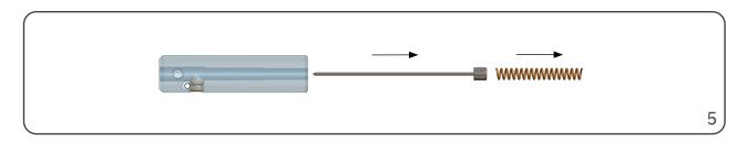
Schritt 5: Druckfeder und Steuerbolzen aus dem Grundkörper herausnehmen, indem die Spitze des Steuerbolzens in Richtung des Grundkörpers gedrückt wird.
