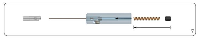
Schritt 7: Die alte Druckfeder wieder in den Grundkörper einfügen, die Stellschraube anbringen und festschrauben, bis diese mit dem Grundkörper abschliesst.
