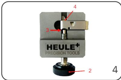
Stellschraube **(2)** der Montagevorrichtung bis zur Kante **(3)** des Modules eindrehen. Die Bruchkante **(4)** der Montagehilfe ist sichtbar.
