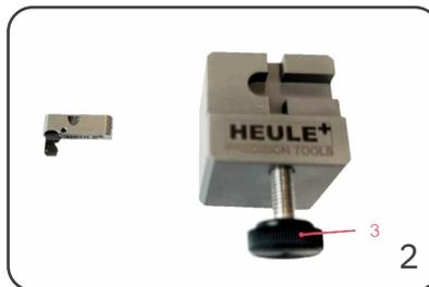
Stellschraube **(3)** von der Montagevorrichtung komplett öffnen.
