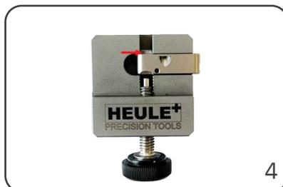
Stellschraube öffnen – das Messer verweilt aus dem Grundkörper ausgefahren.
