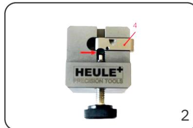
Modul mit Messer (4) in die Montagevorrichtung einlegen, Messer ist zur Stellschraube gerichtet.
