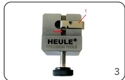
Modul mit Messer **(1)** in die Montagevorrichtung einlegen, das Messer zeigt zur Stellschraube.
