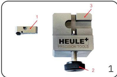
Modul (1) reinigen und Stellschraube (2) der Montagevorrichtung (3) öffnen.
