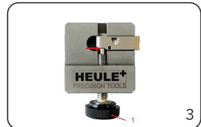
Stellschraube (1) bis zur Freistellung des Messers drehen.
