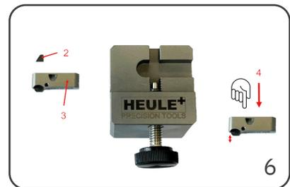
Stellschraube lösen, die Montagehilfe **(2)** fachgerecht entsorgen und das Modul **(3)** entnehmen.
