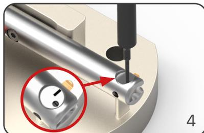
Auf dem Messerhalter sind der Markierungsstrich und der schwarz brünierte Spreizstift sichtbar (S. 57). Spreizstift mit dem Montagestift (kleinerer Ø) durch den Messerhalter durchschlagen (nur eine De-/Montagerichtung!).
