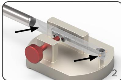
Werkzeug so in die Montagevorrichtung legen, dass der Trägerstift der Montagevorrichtung in die Feder-
