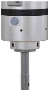
SOLO: la cuchilla se retrae cuando el cabezal está parado. Funciona a una velocidad mínima de activación 1900 r.p.m. La cuchilla solo se extiende hasta la posición de trabajo una vez superada la velocidad mínima. La cuchilla se retrae deteniendo el husillo.
