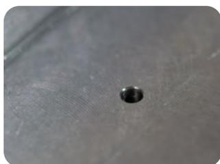
Il processo di taglio definito con una lama rivestita in carburo assicura una completa sbavatura del bordo; il bordo è pertanto privo di bave.
