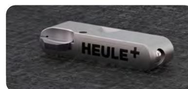
Il modulo è progettato per punte per foratura a partire da un  $\varnothing$  foro di 18,0 mm. Il posizionamento è a circa 25,0 mm dietro la cuspidi di foratura.
