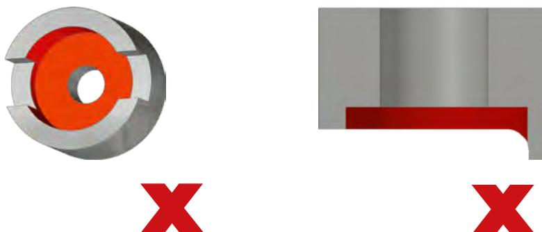
Angoli di inclinazione eccessivi e tagli completamente interrotti, come nel caso di bisellatura, scanalatura, ecc. possono causare danni alla lama e all'utensile.
