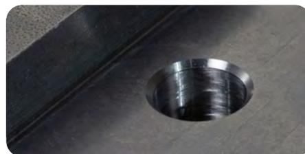
Per fori da Ø5,0 mm a Ø17,0 mm e profondità di foratura da 1xd a 2xd. Per ulteriori soluzioni, vedere **INDIVIDUAL**.
