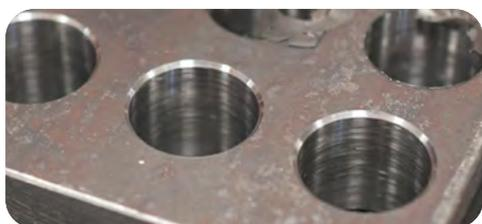
Il risultato è un prodotto pulito e riproducibile con affidabilità. La capacità di smussatura va da 0,5 a 1,0 mm a seconda della lama selezionata.
