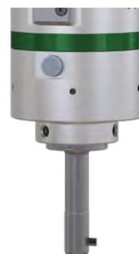
**SOLO2 – La lama è estesa in posizione di arresto (arresto del mandrino).** Questo utensile è progettato per una velocità di lavorazione massima di 1500 giri/min. La velocità di ritrazione della lama nell'alloggiamento lama è di 1900 giri/min.
