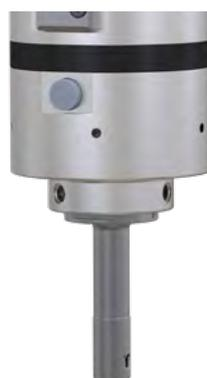
**SOLO – La lama è retratta in posizione di arresto (arresto mandrino).** Funziona a una velocità minima di 1900 giri/min. La lama si estende in posizione di lavoro solo dopo aver superato la velocità minima. Quando si ferma il mandrino, la lama si ritrae.
