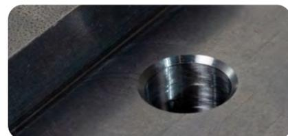
Für Bohrungen ab  $\varnothing 5.0$  mm bis  $\varnothing 17.0$  mm und Bohrtiefen von 1xd bis 2xd. Weitere Lösungen siehe **INDIVIDUAL**.
