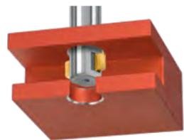
Fasen von asymmetrisch unterbrochenen Bohrungskanten – vor- und rückwärts in einem Arbeitsgang.
