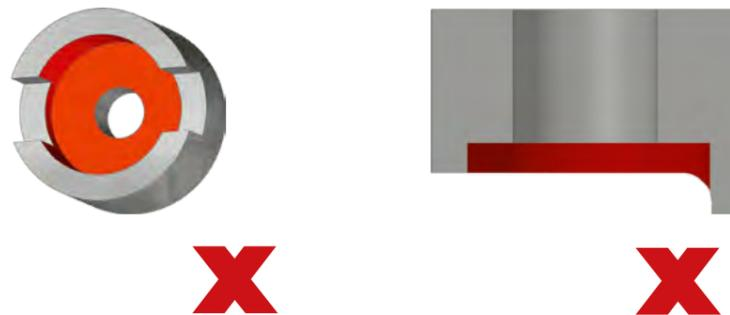
Zu grosse Steigungswinkel und voll unterbrochene Schnitte wie zum Beispiel bei Nuten, Schlitzern, etc. führen zu Messer- und Werkzeugbrüchen.
