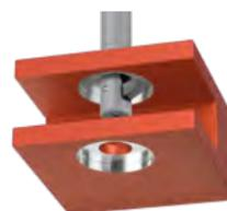
BSF bearbeitet unzugängliche Bohrungen automatisiert und ohne Wenden des Werkstücks. Zuverlässig dank integrierter Messerfensterspülung.
