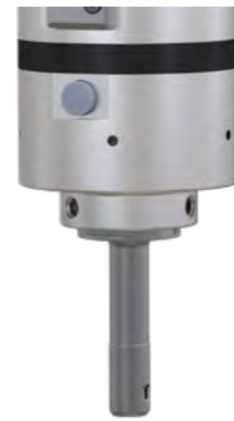
SOLO – Le couteau est rétracté à l'arrêt (arrêt de la broche). Il fonctionne à une vitesse minimale de 1900 tr/min. Ce n'est qu'après avoir dépassé la vitesse de rotation minimale que le couteau sort en position de travail. La rétractation du couteau se fait par arrêt de la broche.
