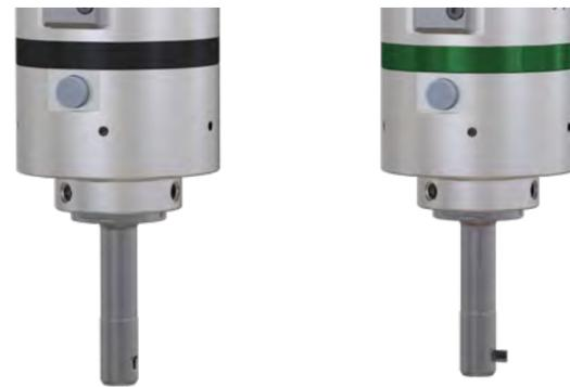
**SOLO: la cuchilla se retrae cuando el cabezal está parado.** Funciona a una velocidad mínima de activación 1900 r.p.m. La cuchilla solo se extiende hasta la posición de trabajo una vez superada la velocidad mínima. La cuchilla se retrae deteniendo el husillo.
