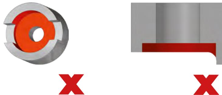
Ángulos muy inclinados y cortes totalmente interrumpidos, como ranuras o muescas, provocan la rotura de cuchilla y herramienta.
