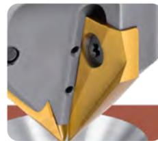
Larga vida útil: el cuerpo de la herramienta hecho de acero aleado templado con un diseño robusto y preciso con refrigeración interna.
